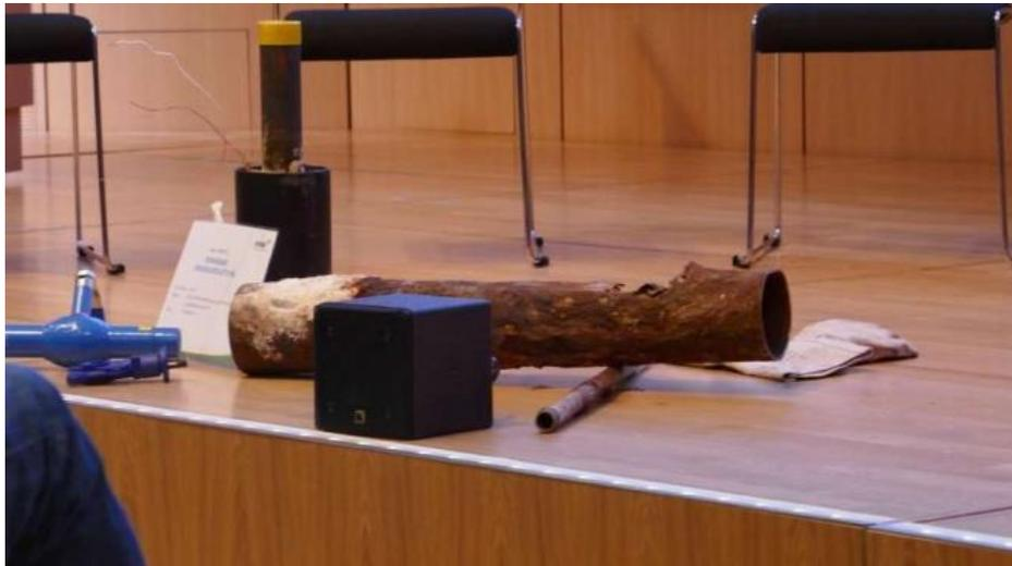
Auch vollkommen technische Laien im Publikum erkannten schnell, dass die SWBB versuchten, sie in die Irre zu führen. Das Loch im dickeren der beiden Rohre auf dem Podium hatte einen Querschnitt von etwa 100 Quadratzentimetern. Bei einem Leck dieser Größenordnung im Fernwärmenetz wäre in kürzester Zeit das komplette Heizwasser ausgetreten, es hätte ein großer Krater an der Leckstelle entstehen können und die entstehende Heißwasser-Fontäne hätte die Feuerwehr auf den Plan gerufen.
